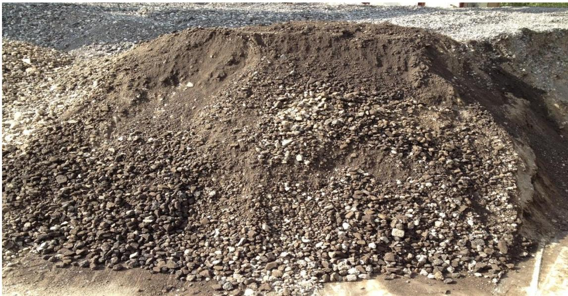
**Recycling – Betonschotter 0 – 60 mm**
